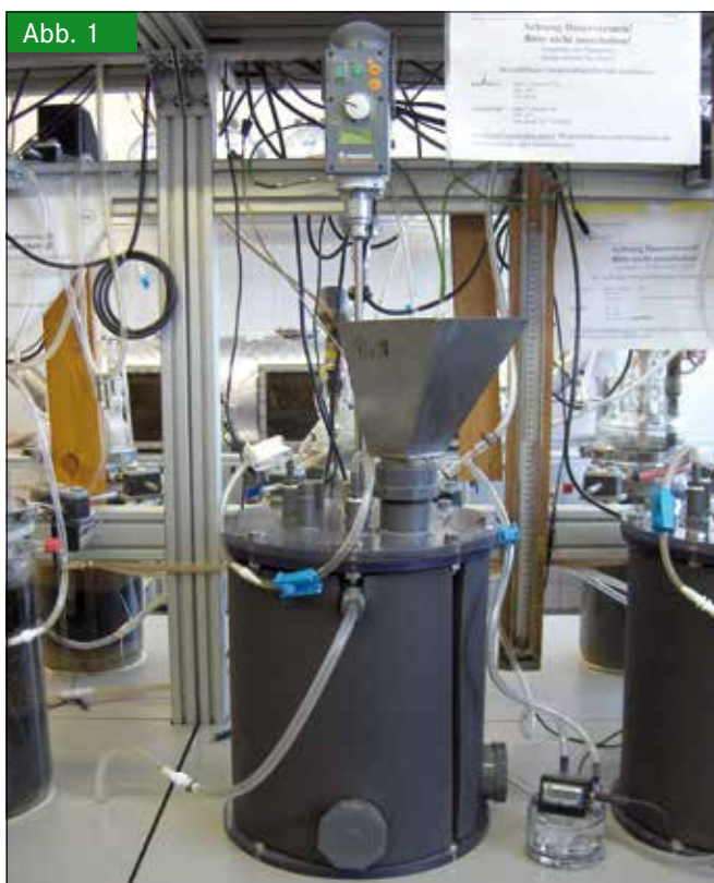
Rührkesselfermenter mit einem Arbeitsvolumen von 10 l Fig. 1: Continuously-stirred-tank reactor with a net volume of 10 l (Foto: C. Beil)
