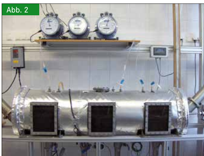
Pfropfenstromfermenter mit einem Arbeitsvolumen von 180 l Fig. 2: Plug-flow reactor with a net volume of 180 l (Foto: C. Beil)
