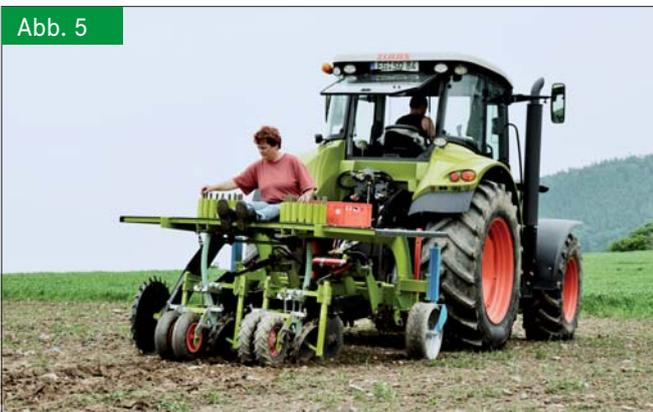
2-reihige, modulare Versuchs-Pflanzmaschine beim Feldtest: Mulch-Pflanzung auf steinigem Boden. Foto: Henke, TU Dresden
