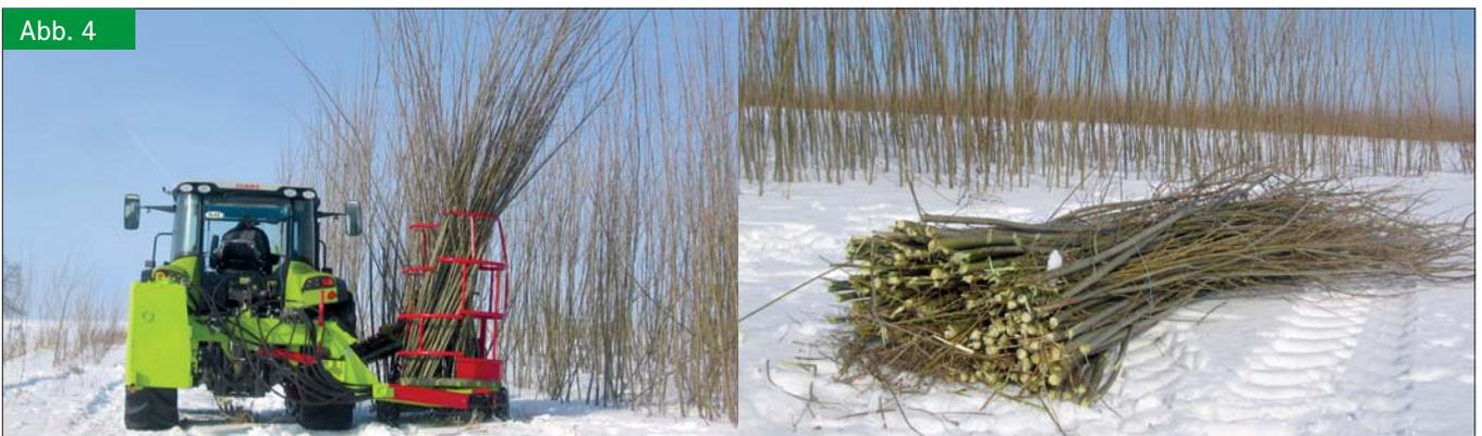
Versuchsmaschine bei der Ernte des Rohmaterials für die Steckholzerzeugung (links), maschinell abgelegtes Rutenbündel (rechts).
