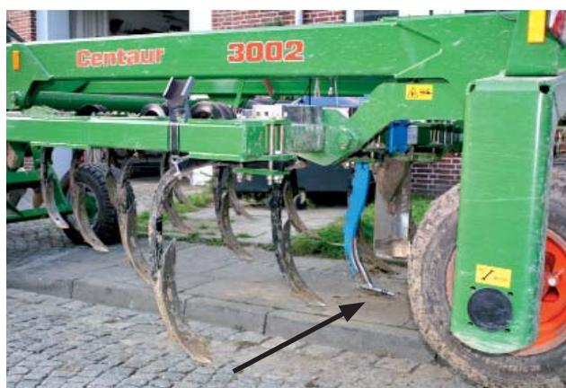
Bodenfeuchtigkeitssensor, montiert am ersten Grubberbalken des Bodenbearbeitungsgeräts
