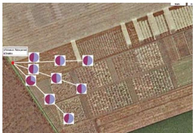
Aufsicht auf das Versuchsgelände. Der rote Punkt markiert die Stelle des Emissionspunktes. An den Positionen der Kreisdiagramme befindet sich jeweils eine Depositionsmessstelle
