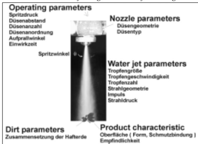
Bild 1 Einflussfaktoren auf den Reinigungsprozess mit Waschdüsen
