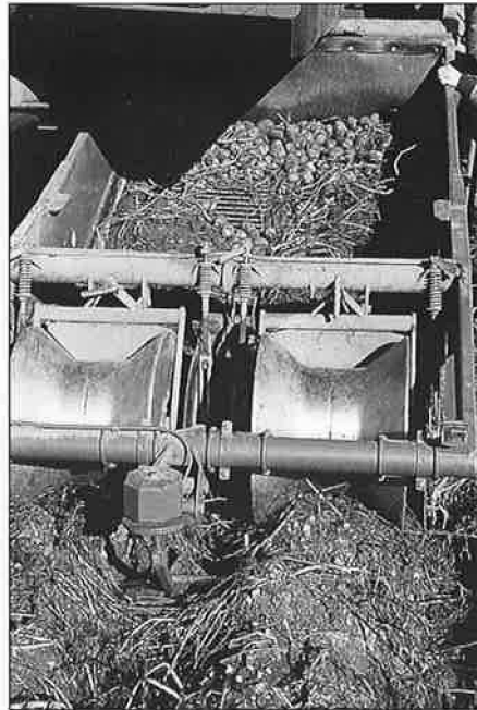
Bild 2: Bei Kartoffelsammelrotern mit seitlicher Dammaufnahme können Maschinenabweichungen auch durch seitlich bewegliche Schleiftaster erkannt werden.
