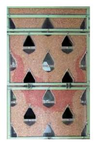
Partikelströmungsprofil gefärbter Weizenkörner in der herkömmlichen Apparategeometrie (Foto: ATB) *Fig. 3: Particle flow profile of the colored wheat particles in the test dryer with traditional design*
