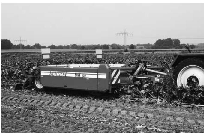
*Bild 3 und 4: Auf das Notwendige reduziert: Speziell für osteuropäische Anforderungen entwickelte Grimme den gezogenen Hochleistungsblattmulcher BM330 (Werkbild links) und die sechsreihige gezogene Zuckerrübenvollerntemaschine Rootster 604 mit 4 t Überladebunker*
