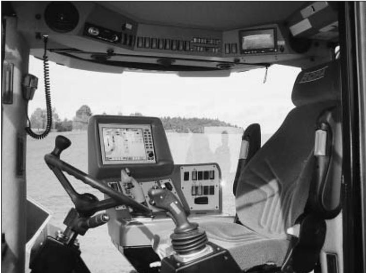
*Bild 2: Blick in die Kabine der euro-Maus 3 von Ropa mit großem und übersichtlichem Terminal (Werkbild)*
