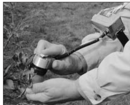
Bild 1: Sensorkopf bei der Messung am Baum
