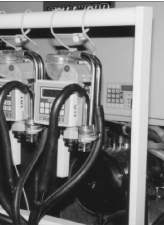
Basierend auf den Ergebnissen der ersten Messreihe wurden die Milchflusssensoren des AMS neu justiert, um eine gleichmäßigere Steuerung des Melkprozesses zu erreichen. Der Erfolg dieser Maßnahme wurde anhand der Ergebnisse der zweiten Messreihe beurteilt.
